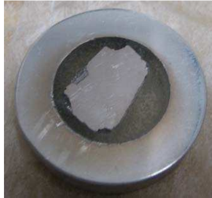
Figura 5.1: Muestra de Bismuto. La misma se monta sobre un anillo de una pulgada de acero y se rellena con un epoxy. Luego se realiza un pulido de la superficie para lograr una reflexión especular del haz de prueba.
