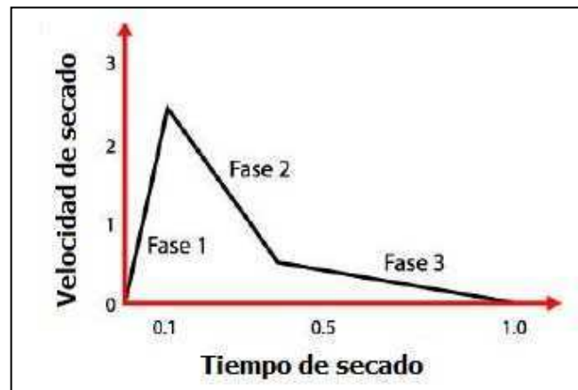
Figura 10. Fases de secado en el proceso de liofilización. Adaptado de Barbosa-Cánovas y Vega-Mercado (1996).
