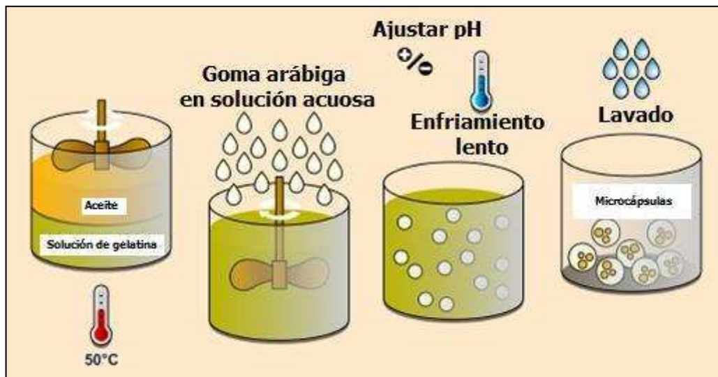
Figura 11. Microencapsulación por coacervación compleja usando gelatina y goma arábica.
