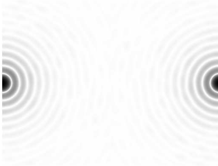
Figura 5.3: Imagen de un objeto ubicado en el borde izquierdo de la imagen, obtenida a partir del producto de la transformada de Fourier de dicho objeto con la TF del sistema, y antitransformando.
