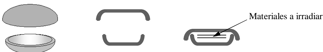
Figura 4.4.: Cápsula para irradiación bajo cadmio
