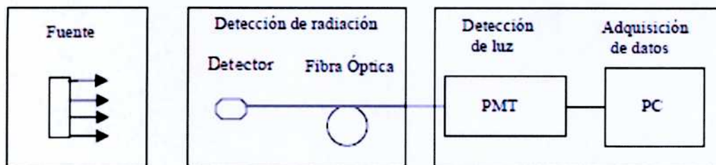
Figura 9. Esquema del sistema de DFO (Molina, 2010).
