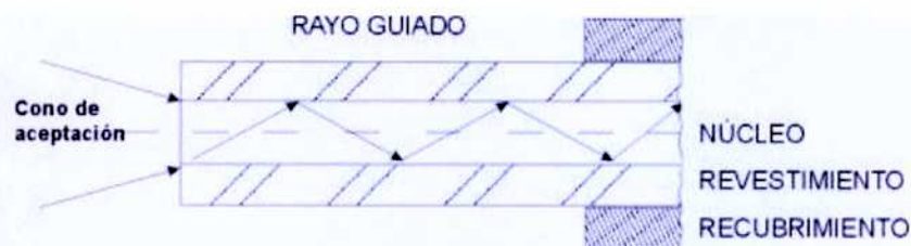
Figura 5. Propagación de la onda dentro de la Fibra óptica ( http://platea.pntic.mec.es/~lmarti2/fibra.htm ).
