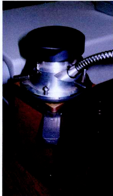
Figura 14. Sistema de medición #1. Se observa el bundle de FO de sílica inserto en dirección oblicua.
