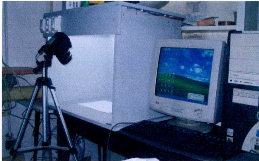
Figura 3.3 Sistema de visión computarizada para la adquisición de imágenes.
