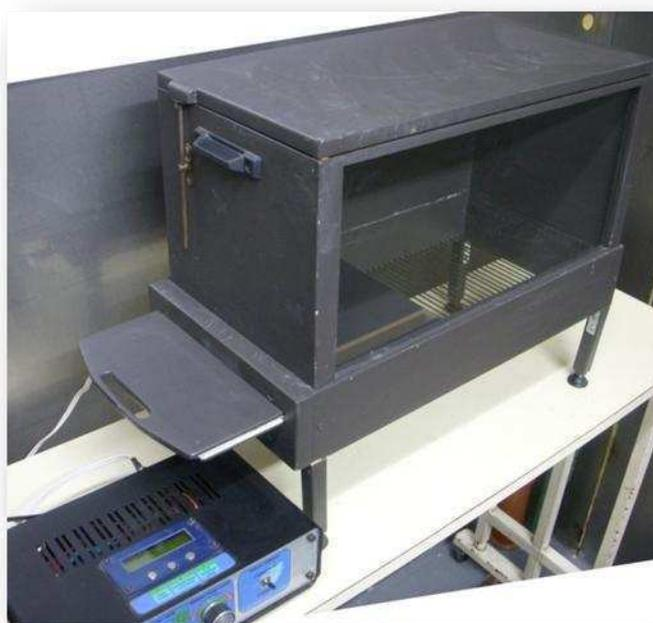
Figura 65. Aparato de evitación inhibitoria.
