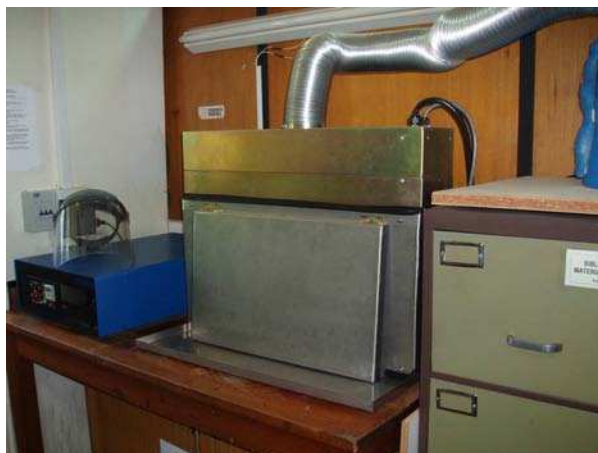
Imagen III.1. Sistema de esterilización Steripulse-XL modelo RS-3000B, módulo controlador RC747 y sistema de ventilación
