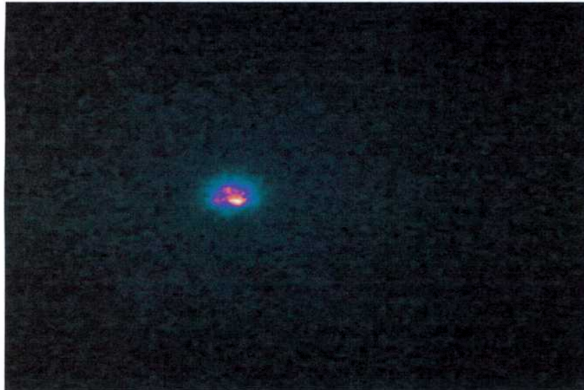
Figura 4.7. Imagen Planar de la fuente de ^{90}\text{Y} ubicada en el inserto D5, adquirida en el SPECT Elscint SP4, usando el colimador de baja energía, y una ventana energética de 41%. Aplicándole un algoritmo de corrección iterativo.
