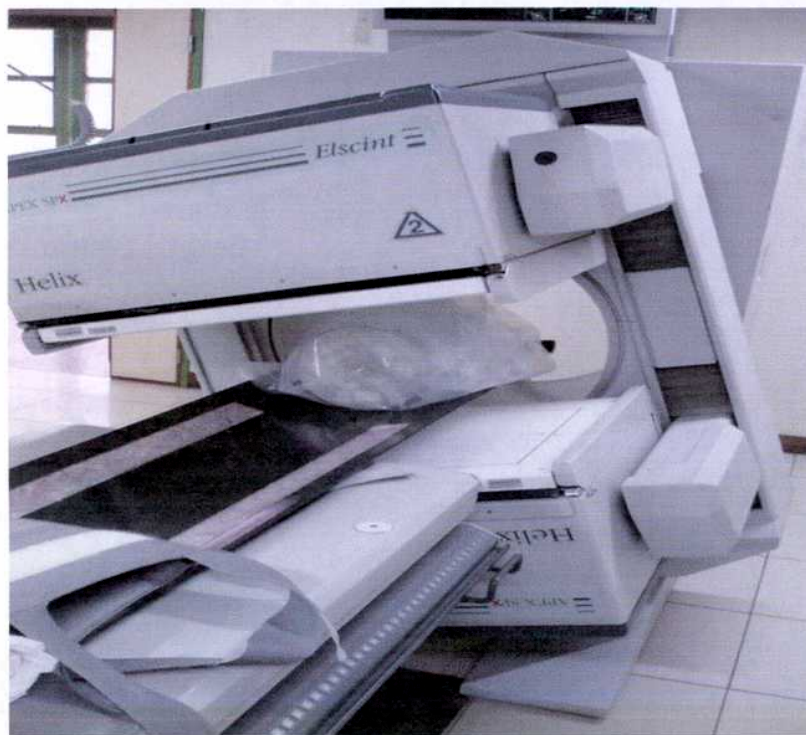
Figura 4.25 SPECT Elscint Helix, de doble cabezal, adquiriendo en el fantoma, las imágenes del ^{90}\text{Y} .
