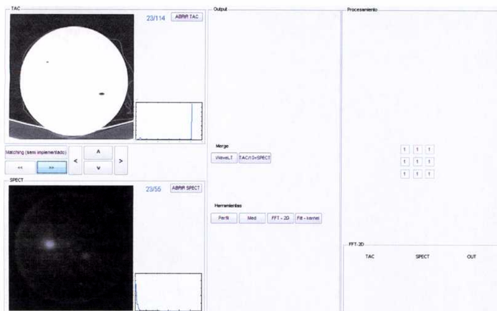
Fig. 4.29. Muestra cómo se puede abrir en una sola ventana las dos imágenes del fantoma, la correspondiente al CT de una matriz de 1024x1024, y de 114 frames y la de SPECT, estas imágenes fueron adquiridas en una matriz de 128x128 y 55 frames. Se observa igualmente el histograma de cada imagen. Es evidente la diferencia en la resolución de las imágenes así como la matriz de cada uno.
