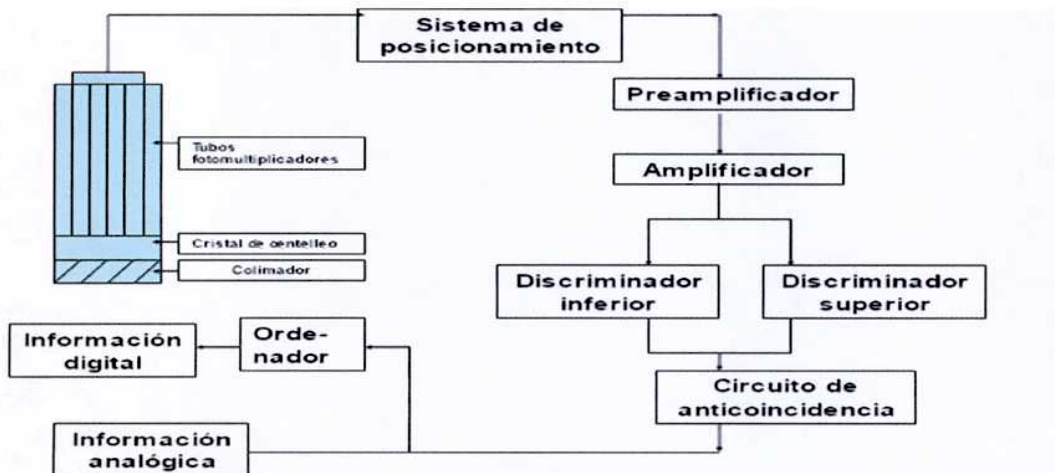
Figura 2.3. Esquema de un cabezal, y estructura interna de una cámara gamma.
