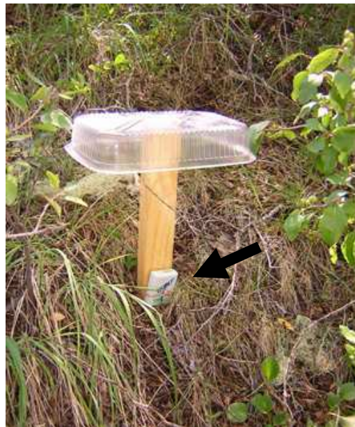
Fig. II.4. Sistema utilizado para colocar el sensor de temperatura en el campo. La flecha indica la posición del sensor en el soporte de madera.
