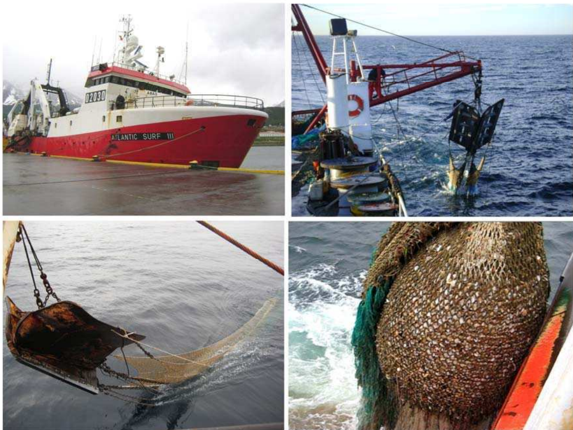
Figura 2. Barco comercial de 59 metros de eslora. Red de arrastre con portones.
