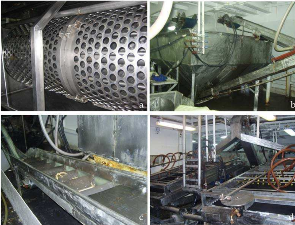
Figura 4. Planta de procesamiento a bordo. a. Cilindro selector de vieiras b. Tolva, recibe la captura < 55 mm c. Cinta transportadora d. Máquina de pelado.
