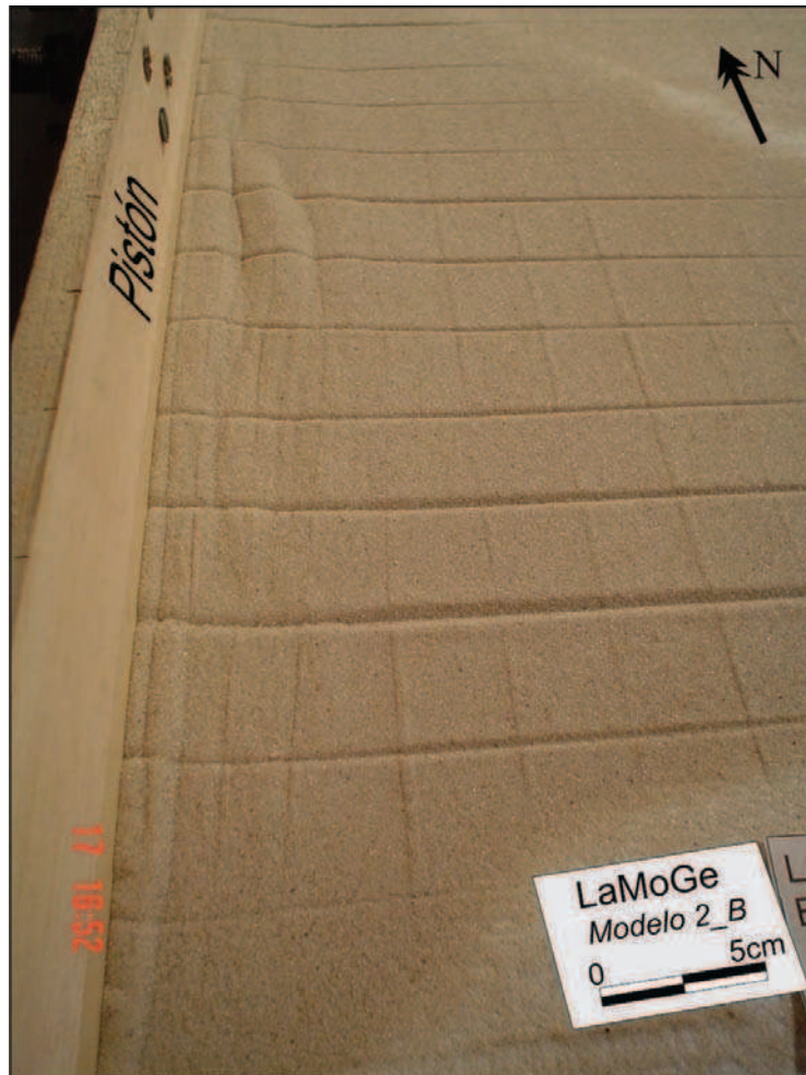
Figura 6.30: Fotografía tomada en la etapa final de la evolución del modelo 2_B. Nótese la convexidad hacia el antepaís del frente de deformación y las escarpas definidas sobre la superficie.
