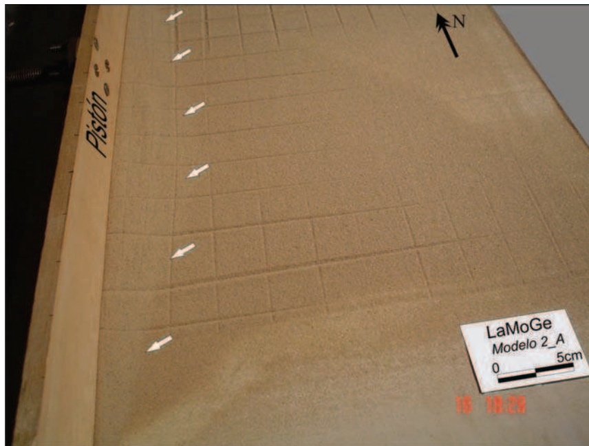
Figura 6.27: Fotografía tomada en la etapa final de la evolución del modelo 2_A. Las flechas señalan la ubicación del quiebre topográfico que define el pie de la cuña de deformación; nótese su convexidad hacia el antepaís y la ausencia de escarpas definidas sobre la superficie.
