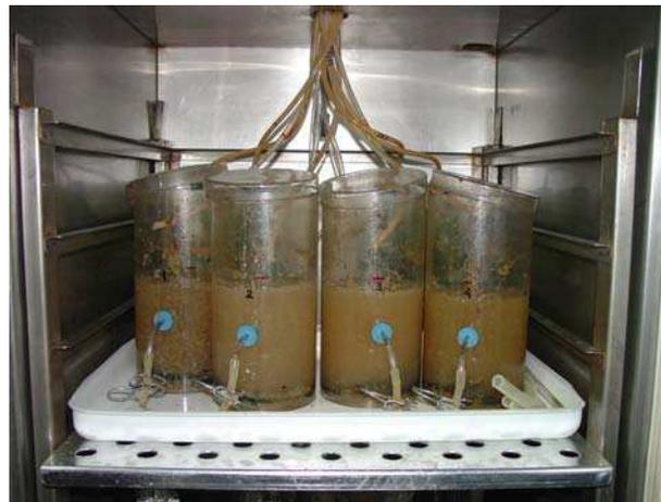
**Figura 6.** Reactores de barros activados a escala de laboratorio.
