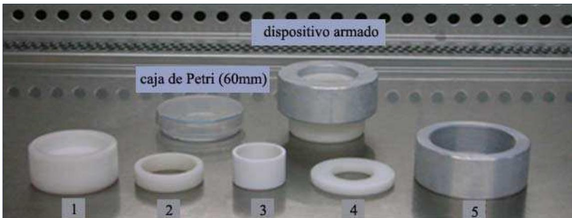
**Figura 9. Dispositivo utilizado para estirar células in vitro.** Imagen que muestra al dispositivo armado y a las piezas individuales que lo forman (1-5). La caja de Petri de 60 mm de la fotografía es una referencia de las dimensiones del dispositivo.
