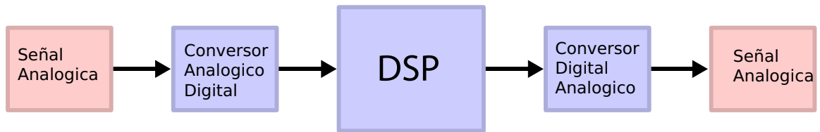
Figura 4.10: Esquema del procesamiento digital de señales. El mismo sigue una secuencia de conversión analógica-digital de una señal de entrada, manipulación digital en el DSP y conversión digital-analógica de la señal de salida.
