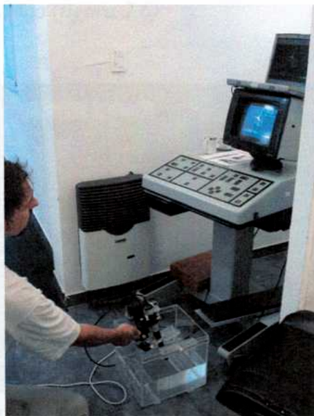
Figura 2.4 Calibración de transductor rectal con la plantilla y el ecógrafo.
