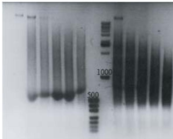
**Figura 21** La fotografía que se muestra es representativa de la puesta a punto realizada para la obtención de fragmentos que se encuentren entre 500-1000 pb.
