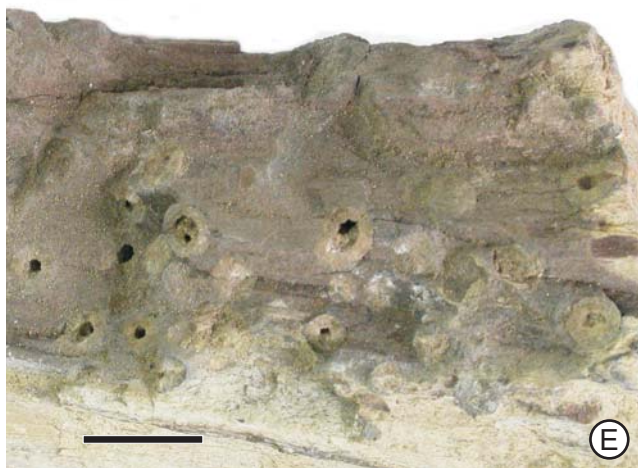
Figura 50. Biodeterioro de maderas por hongos (A-B) y teredos (C-F)
