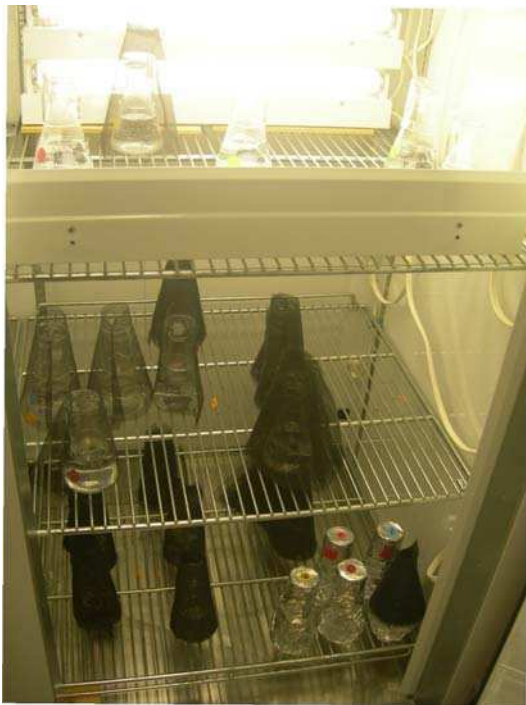
Lámina 1-IV. Diseño experimental. Para lograr las distintas irradiancias se utilizaron mallas oscuras neutras (de 0 a 5) y distintas posiciones dentro de la cámara de cultivo respecto de la fuente de luz.
