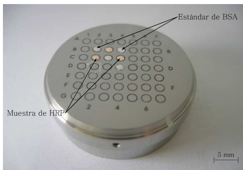
Figura 3.9: Siembra de muestras en una sonda metálica de 49 posiciones.
