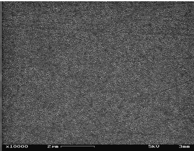
Figura 4.10a: Micrografía de una pastilla Z8Y obtenida a partir de un polvo comercial de Nextech Materials.
