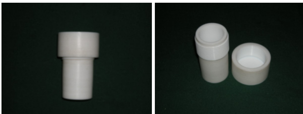
Figura 4.11 Recipiente de teflón para las reacciones de microondas.
