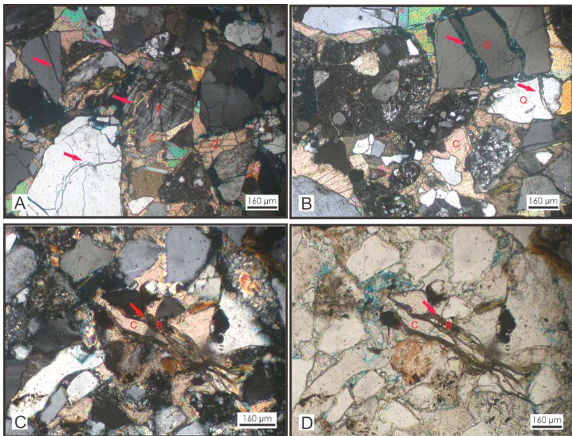
Figura XIV.5: Crecimiento desplazante del cemento carbonático, nótese el desplazamiento y fracturamiento de tectosilicatos (feldespatos (F) en A y cuarzos (Q) en B ) como también en filosilicatos (B: biotitas) en C y D .
