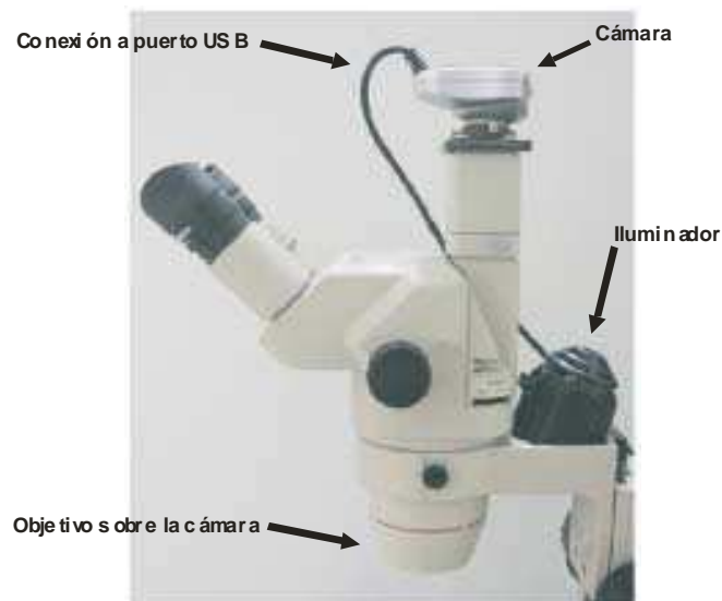
Figura 3.4. Detalle de la videocámara montada sobre la lupa estereoscópica.
