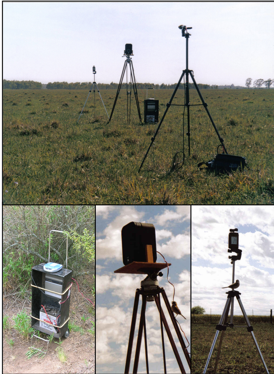
Figura 3.1 - Equipo utilizado para realizar los experimentos de transmisión. Arriba: vista general del equipo, que incluye el equipo de emisión en el centro (el parlante sobre el trípode a una altura de 1,8 metros, conectado a un amplificador alimentado por una batería, que a su vez estaba conectado a un discman), el equipo de grabación en primer plano (el grabador en el suelo conectado al micrófono, que a su vez estaba colocado en un trípode a 1,5 metros de altura), y el anemómetro al fondo (también montado sobre un trípode). Abajo izquierda: detalle de parte del equipo de emisión. Abajo centro: detalle del parlante montado sobre el trípode. Abajo derecha: detalle del anemómetro montado sobre el trípode. Nótese la presencia de un individuo de chingolo en el trípode del parlante (abajo centro) y en el trípode del anemómetro (abajo derecha); esto se debe a que cuando los cantos eran transmitidos dentro del territorio de un macho, éste respondía cantando y, en algunos casos, aproximándose al parlante.
