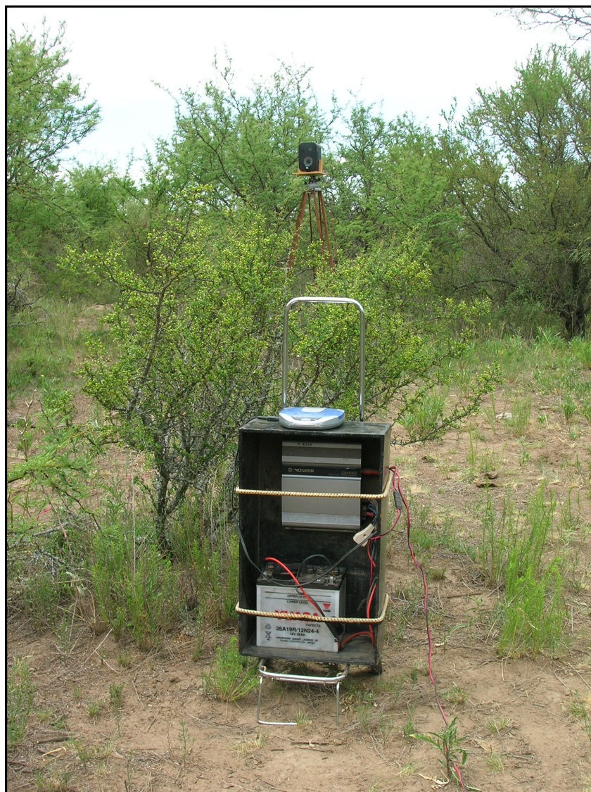
Figura 4.2 - Equipo utilizado para la emisión de los estímulos en los experimentos de playback. En primer plano se observa el discman conectado al amplificador, que a su vez es alimentado por una batería de auto, y al fondo el parlante puesto sobre un trípode a 1,8 metros de altura. El amplificador y el parlante están conectados por un cable de unos 30 metros de longitud, que permite manejar el equipo y realizar la observación a una distancia que afecte lo menos posible la conducta de los sujetos experimentales
