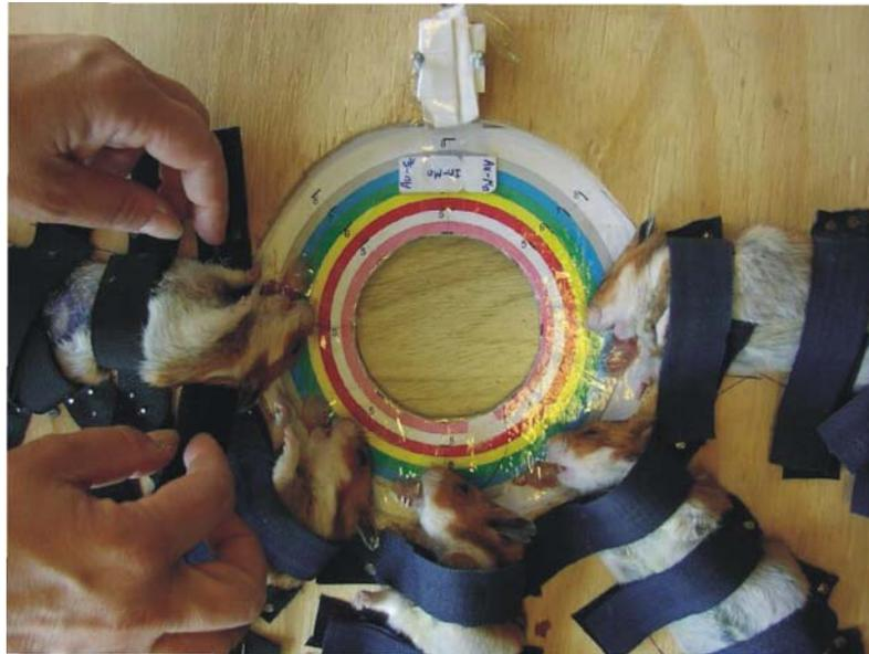
**Figura 13:** Dispositivo de irradiación donde se posicionan los animales. La circunferencia central del dispositivo corresponde al diámetro de salida del haz de neutrones y los colores marcan un gradiente de dosis.
