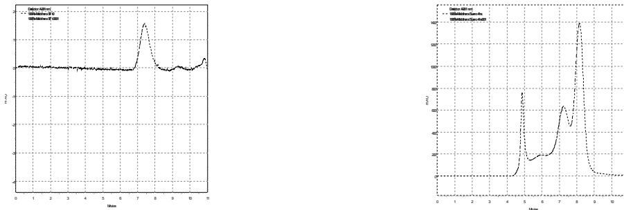
Fig 49 b Cromatogramas UV HPLC de ^{188}\text{Re-AcMo} anti-CD20 (radiomarcado por método directo) en SF (izquierda) y en suero humano (derecha) a tiempo 0 h.
