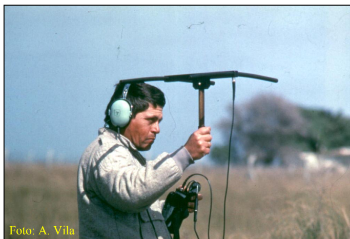
Figura 6.2. Búsqueda de señal de los venados con radiocollares VHF con receptor Telonics TR4 y antena Yagi de cuatro elementos.
