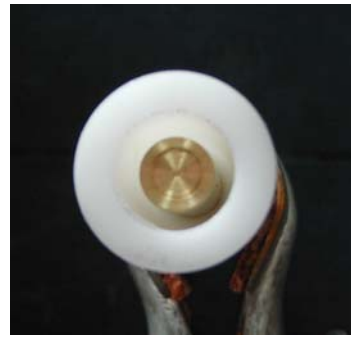
(b) Barra de bronce dentro del cilindro de delring
