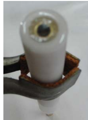
(d) Relleno de la cavidad con araldit
