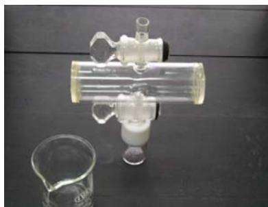
Figura VI.2: Celda para medir los vapores liberados por espectroscopía IR. Se compara su tamaño con el de un vaso de precipitados de 50 mL.
