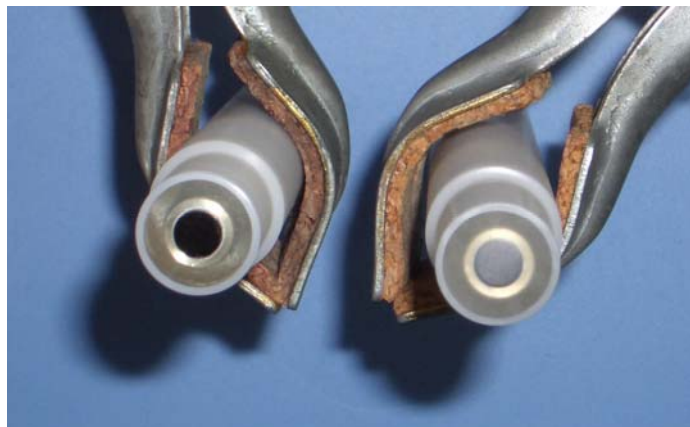
(e) Electrodo pulido (izquierda) y electrodo sin pulir (derecha)
