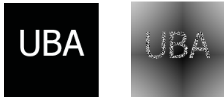
Figura 4.2: Imagen a encriptar y distribución de fase de la escena empleada para representarla. Los niveles de gris corresponden a valores de fase en el rango [0, 2\pi] .
