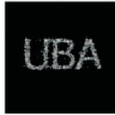
Figura 4.5: Imagen desencriptada. Resultado obtenido al emplear la imagen 4.4(a) cuando el proceso completo es simulado numéricamente.
