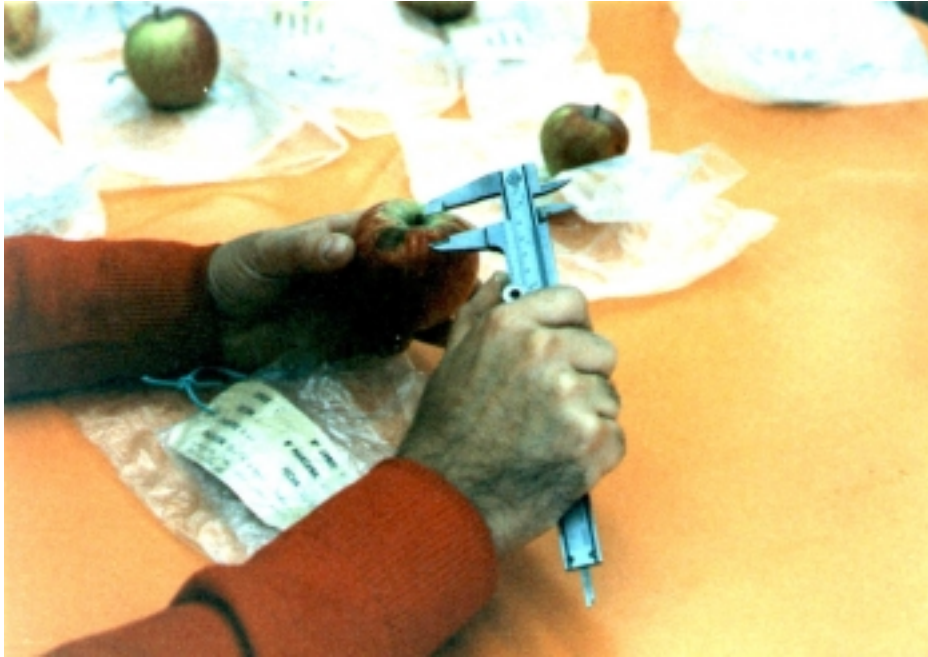
Foto W: En el laboratorio con un calibre se mide el tamaño de la impronta en la manzana.
