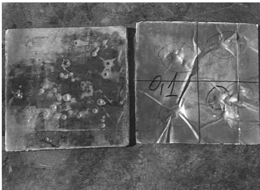
Foto J: Placas de Tergopol con láminas de Aluminio, construidas y ensayadas por el autor en la Universidad Nacional del Comahue.
