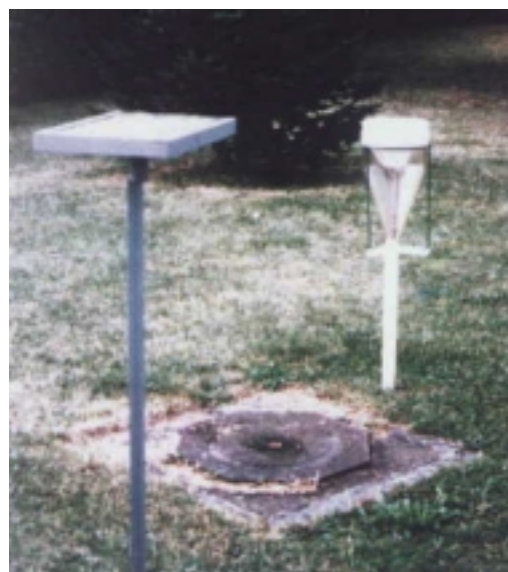
Foto C: De frente, un impactómetro simple Francés como el que se utilizó en Grossversuch IV. Detrás, un impactómetro con un dispositivo para recoger granizos y conservarlos
