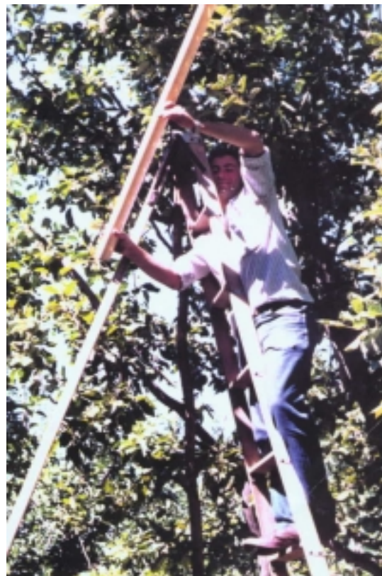
Foto S (derecha): Impactando frutos de manzana con bolillas orientadas con un tubo que tenía alturas previamente calibradas para que la bolilla al impactar con el fruto tuviera la misma energía cinética que un granizo verdadero del mismo tamaño.
