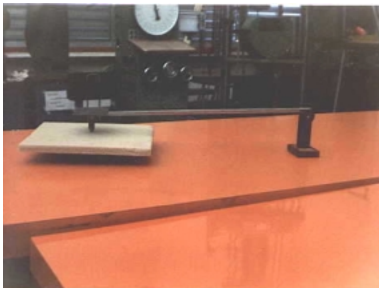
Foto K: El durómetro construido en la Universidad Nacional del Comahue para el control del material de espuma de poliuretano (Estisol), con que se construyeron las placas sensoras en la Red de Impactómetros del Alto Valle de Río Negro y Neuquén.
