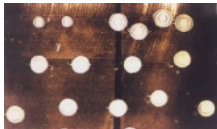
Fotos F: Distintas improntas según el diámetro de bolilla lanzada para simular un granizo equivalente (para el cómputo a veces conviene pintar la placa impactada, de negro para realzar el tamaño de las improntas).
