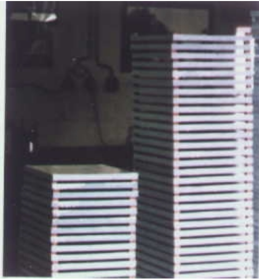
Foto M: Stocks de placas, próximas a ser instaladas en los porta impactómetros, luego del control de calidad.
