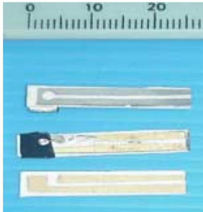
Figura~2-7: vista del calefactor ( dorso del sustrato de alúmina); del dispositivo ya montado sobre el sustrato, y detalle de los electrodos de contacto con escala milimétrica de referencia
