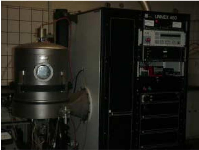
Figura~2-8: Plataforma para "sputtering" de corriente continua LEYBOLD UNIVEX 450
