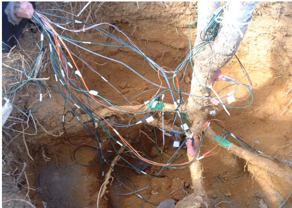
Foto 1. Sistemas de pulsos de calor para la medición de flujos de agua instalados en las raíces y en el tronco de un individuo de Kielmeyera coriaceae .
