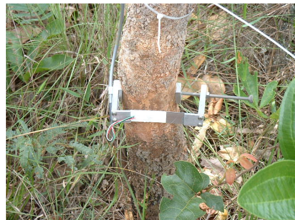
Foto 2. Dendrómetro electrónico (Dynamax Inc. Houston TX, USA) instalado cerca de la base de un árbol de S. macrocarpa .
