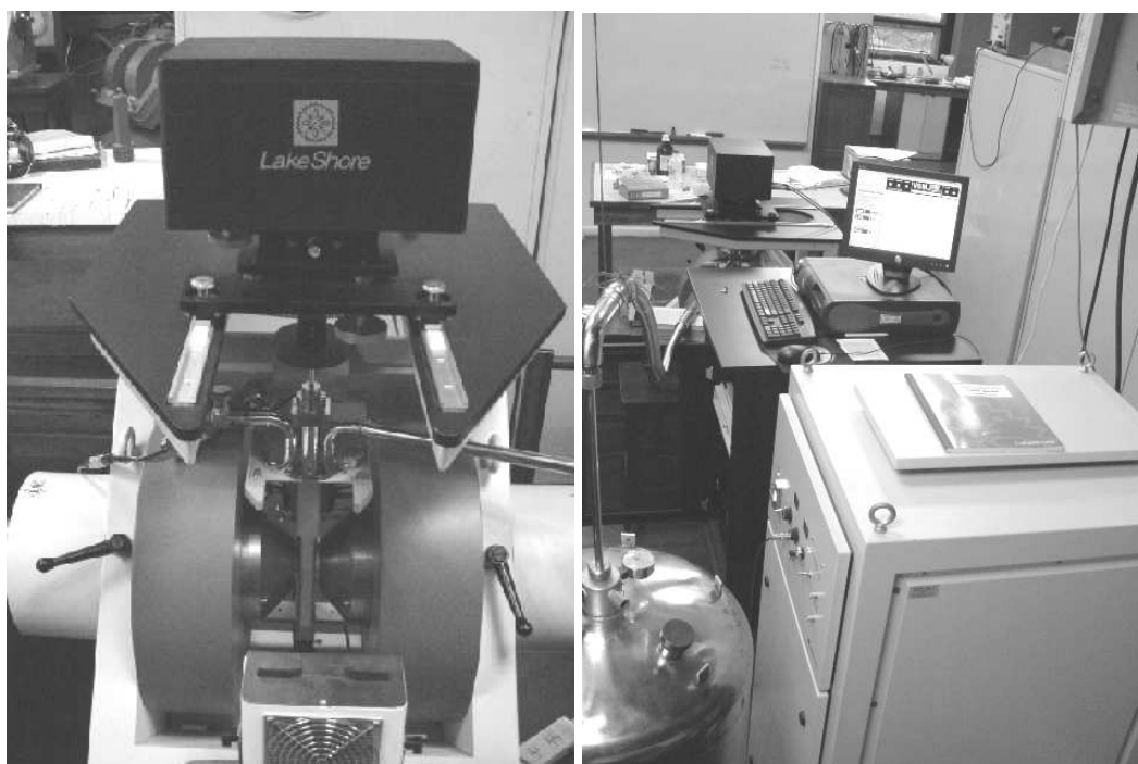
Fig. 2.16: Fotografía del magnetómetro de muestra vibrante LakeShore modelo 7407. (Izq.) El vibrador de la muestra, parte superior, junto con el electroimán de entrehierro variable y el crióstato, parte inferior exterior e interior, respectivamente. (Der.) Electrónica asociada, en primer plano la fuente de alimentación del electroimán junto con el termo para el líquido criogénico, más atrás la isla de medición, donde se aloja el amplificador lock-in, el controlador de: temperatura y del vibrador de la muestra, y el ordenador; por detrás magnetómetro de muestra vibrante.
