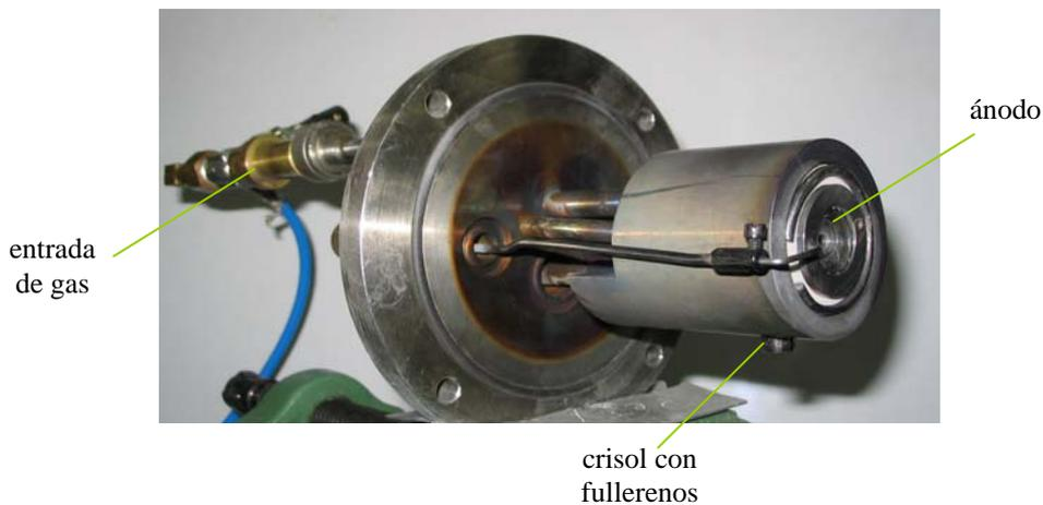
**Figura 2.2.** Fuente de iones del equipo utilizado para producir películas delgadas de C a partir de un haz de iones de  $C_{60}$ .
