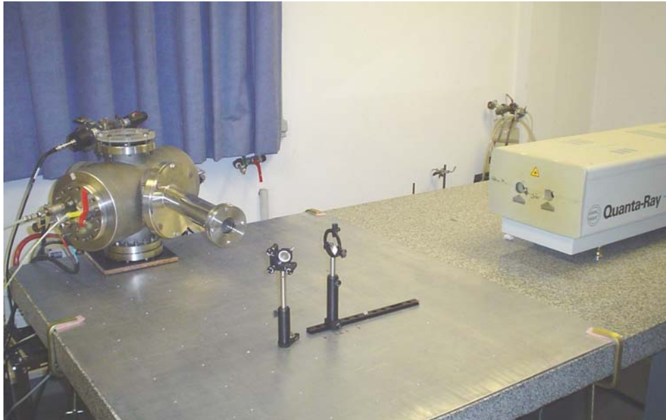
Figura 3.16: Fotografía del Sistema de Ablación Láser..
