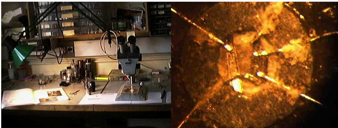
**Figura 5.2:** Izquierda, lupa de 10 a 60 aumentos utilizada para realizar los montajes. Derecha, fotografía de un montaje realizado durante el transcurso de esta tesis (manómetro de plomo a la izquierda, a dos terminales, y muestra de Sr<sub>2</sub>CoO<sub>3</sub>Cl, cobaltita, a la derecha, a cuatro terminales).
