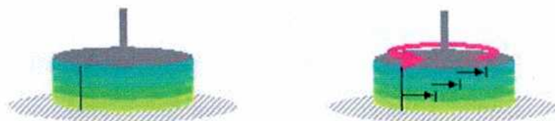
Figura 30: Esquema del flujo laminar en un reómetro rotacional.
