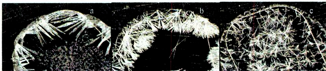
Fig. 4.6. Imágenes de las matrices: (a) 2,5-DHB, (b) y (c) harmano. Magnificación 150 \times .
