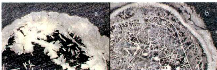
Fig. 4.9. Imágenes de sistemas analito-matriz dopada: (a) Fracción F4'-2,5-DHB-HIQ y (b) Fracción F4'-2,5-DHB-harmano. Magnificación 150 \times . Método C.
