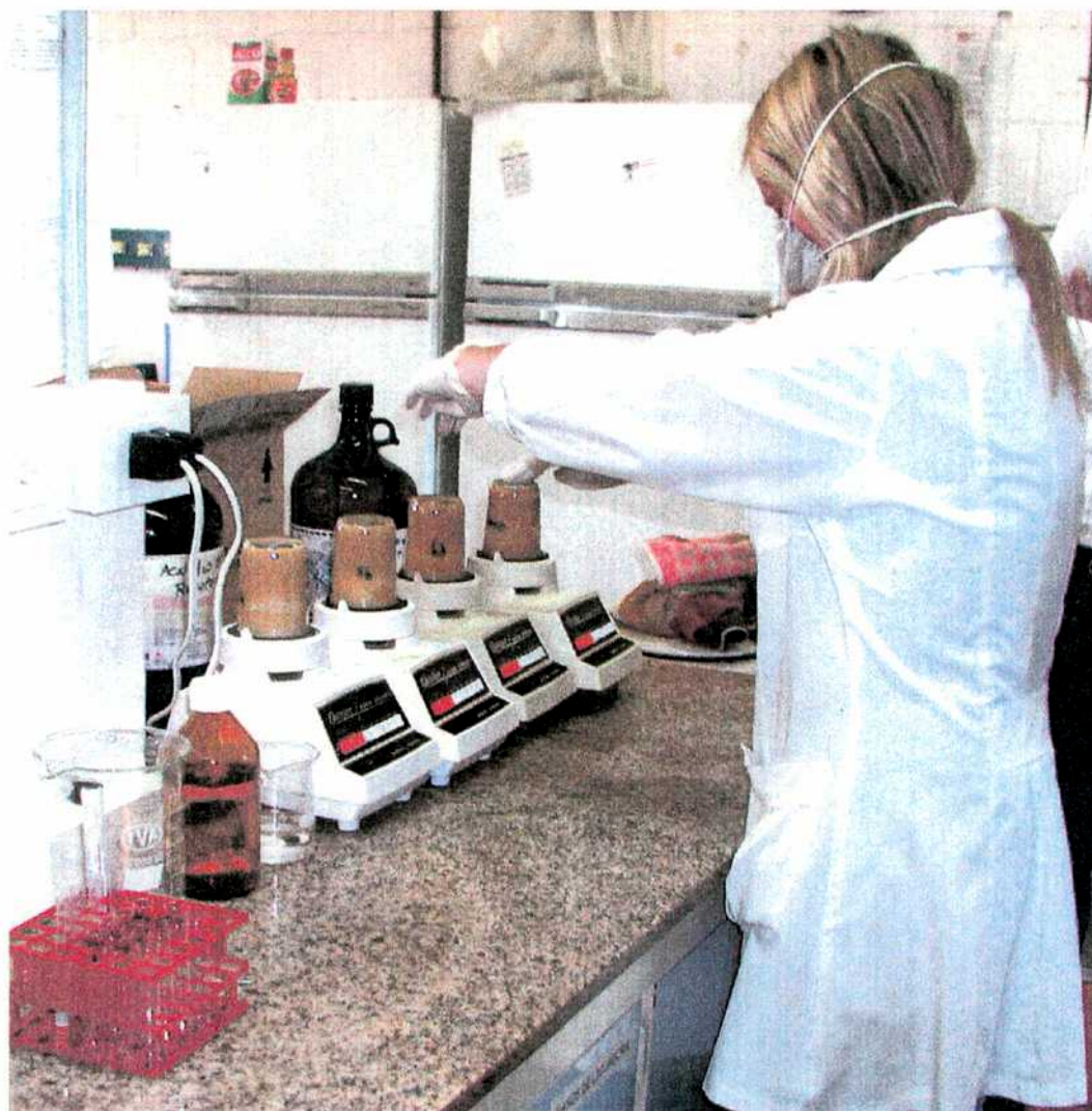
Figura IV.4: Extracción de las toxinas de la matriz alimentaria. Agitación
