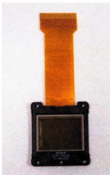
Figura 4- 3: imagen de una de las pantallas con su cable de conexión original
