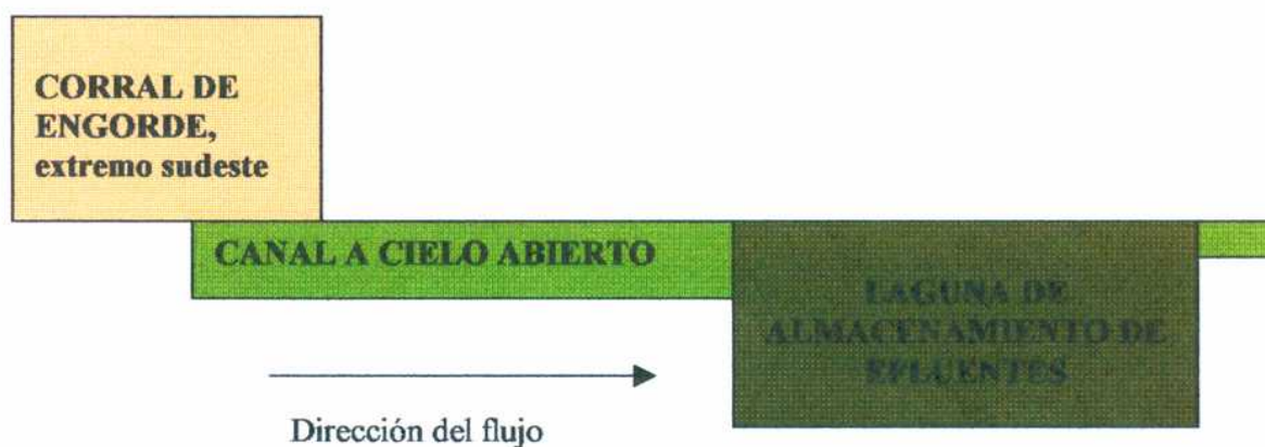
Figura 5. Esquema del Sistema de Conducción y Almacenamiento de Efluentes (No a Escala)
