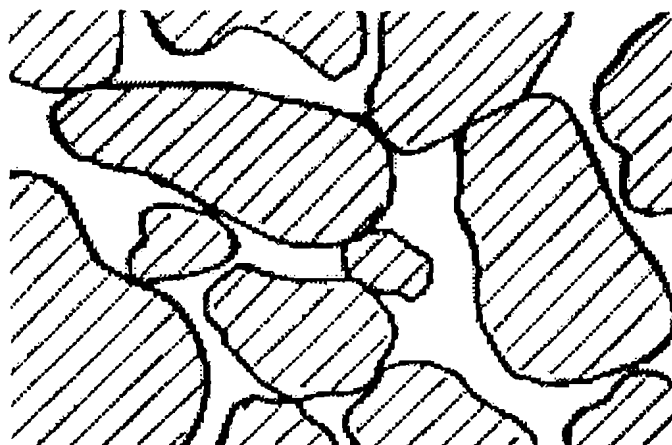
Figura 1.3: Estructura de un medio poroso. Las zonas rayadas indican la fase sólida, y las zonas en blanco son los poros.
