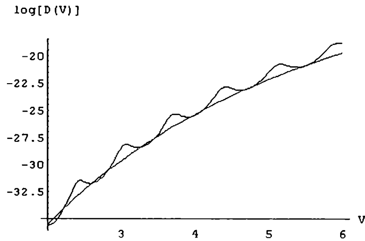
Fig. 2.13 - Probabilidad de túnel para ambos métodos en función del voltaje. La energía de referencia es el nivel de Fermi E_f .
