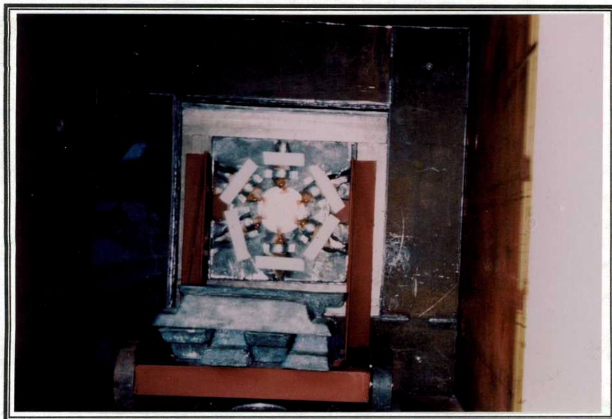
Fig. 18: El dispositivo de irradiación fue construido en plomo, con cavidades para albergar el cuerpo de los animales. Luego de posicionar los animales correctamente se acercó el dispositivo hacia la pared del reactor. Obsérvese la circunferencia central del dispositivo que corresponde al diámetro de la salida del haz de neutrones.
