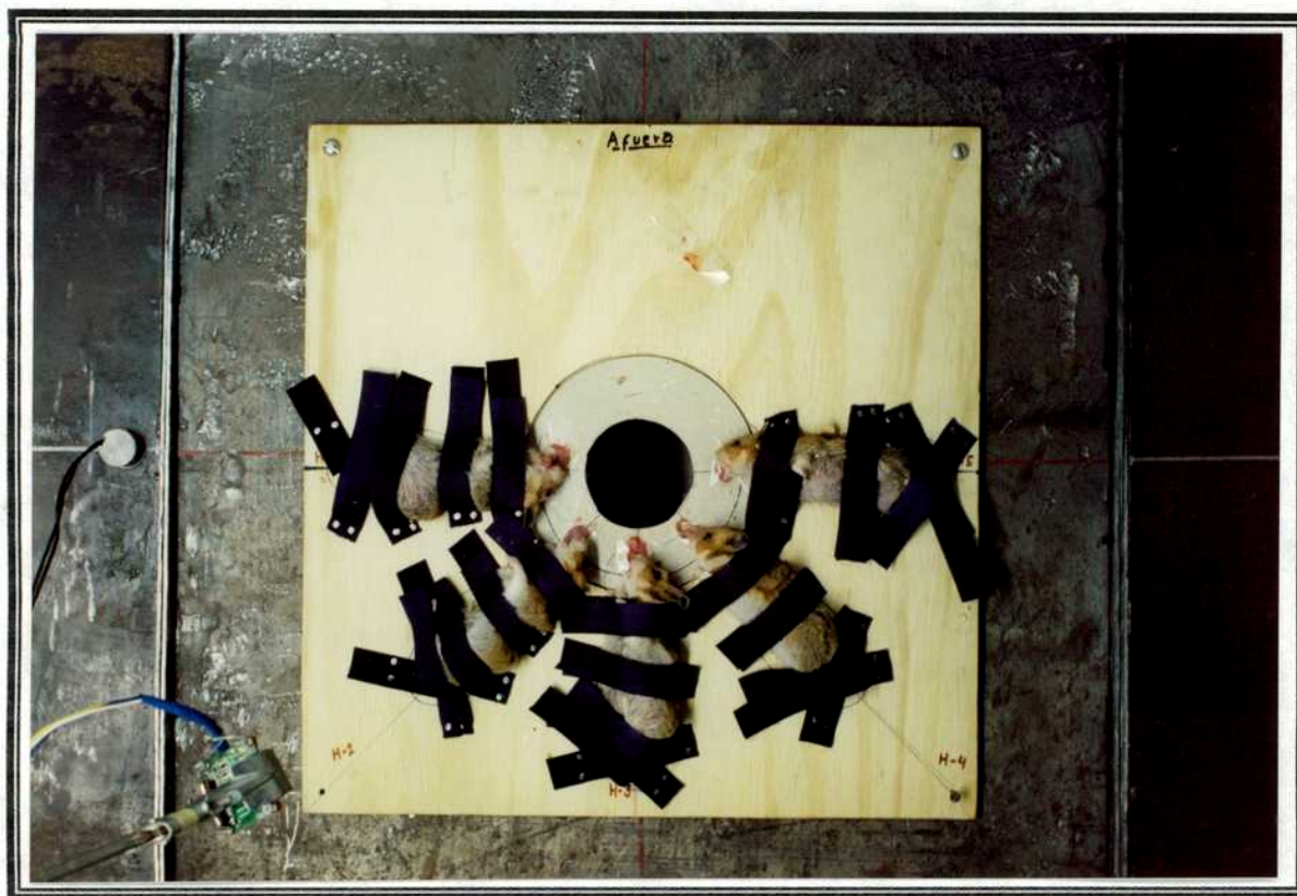
Fig. 44: Dispositivo de irradiación. La foto muestra los Hámsters posicionados, anestesiados e inmovilizados en el dispositivo de irradiación. El mismo fue construido en madera con una apertura central de 15 cm de diámetro correspondiente a la salida de haz de neutrones (perpendicular al plano de la foto). Sobre esta apertura se colocó una lámina de cartón duro en el centro para poder fijar las bolsas de la mejilla evertidas. Sólo una parte de la cabeza también fue expuesta al haz.
