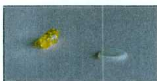
Foto VI.3: Diferentes formas de los xerogeles obtenidos. El monolito amarillento corresponde a un gel de composición inicial como sistema VI y el disco a 0.2/0.2/0.3.
