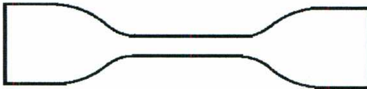
Figura 4.4 Forma de las probetas para ensayos de tracción.
