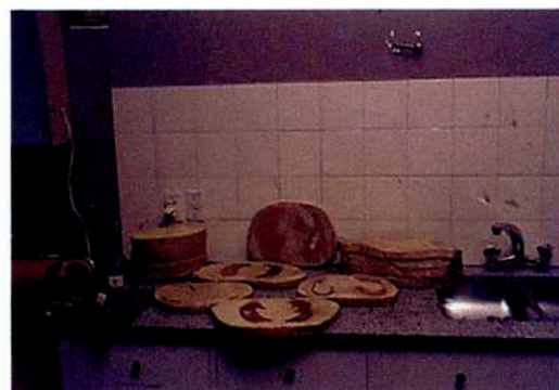
d - Vista interior de la construcción de los fantomas con el pulmón incorporado con las densidades correspondientes.
