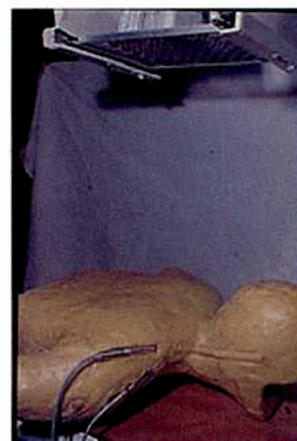
f - Fantoma en posición decúbito ventral. Medición de la dosis de ganglios axilares en superficie.
