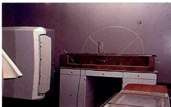
a - Fantoma de agua de 1,80 m de largo, utilizado para mediciones a grandes distancias fuente superficie sin considerar la forma del paciente.
