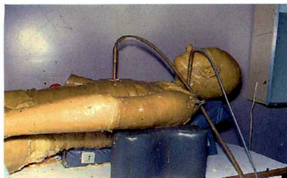
c - Armado del fantoma en la mesa de tratamiento. Vista de las cámaras de ionización para efectuar mediciones de dosis en distintos puntos.
