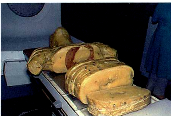
e - Vista interior de mediciones con cámaras de ionización y placas radiográficas. Fantoma utilizado en la medición de campos supradiagmáticas.
