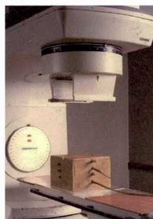
d - Fantoma de rutina de cera para medición a distintas profundidades e intercomparación entre agua y cera.
