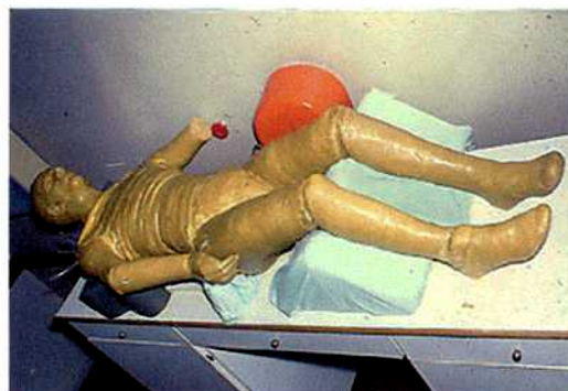
b - Fantoma de cera para la irradiación corporal total. Tiene en cuenta la forma del paciente y su posicionamiento.
