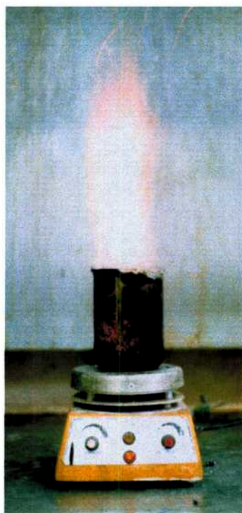
Figura 4.30: Proceso de combustión para la obtención de polvos de dióxido de estaño nanocristalinos, partiendo de estaño metálico con una proporción de 6 moles de ácido cítrico por mol de estaño.
