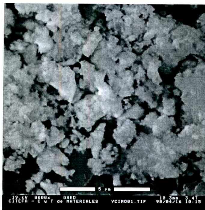
Figura 4.12: Micrografía ESEM de los polvos de \text{ZrO}_2 - 2.8 %molar \text{Y}_2\text{O}_3 obtenidos luego del proceso de molienda. La barra corresponde a 5 \mu\text{m} .
