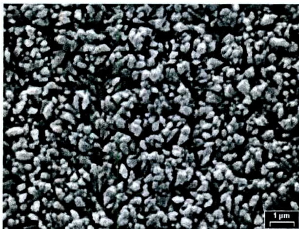
Figura 4.43: Microestructura de una película delgada de \text{SnO}_2 depositada por “flash-pyrolysis” tratada a 650^\circ\text{C} durante 2 hs. La barra corresponde a 1 \mu\text{m} .
