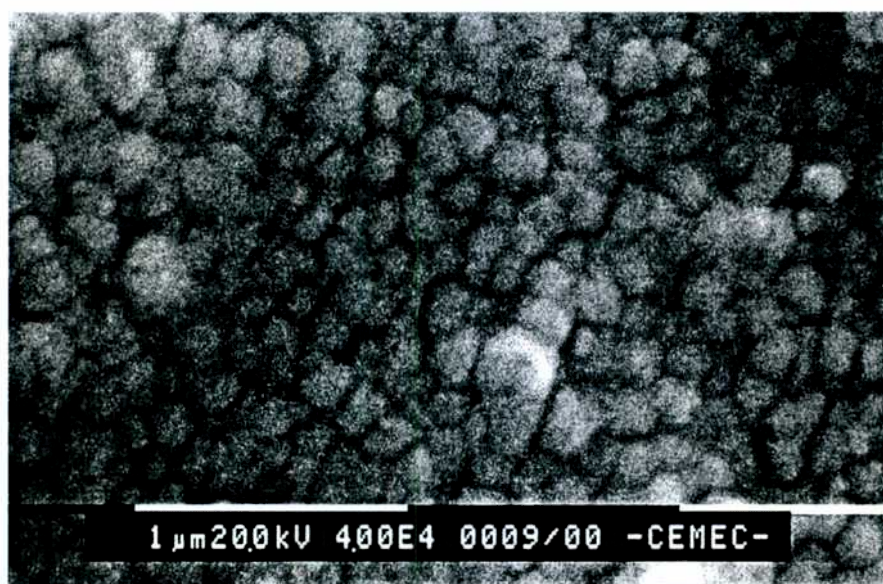
Figura 4.23: Micrografía de cerámicos de Ca-TZP ( \text{ZrO}_2 - 4 %molar CaO) sinterizados a 1500°C durante 3 min.
