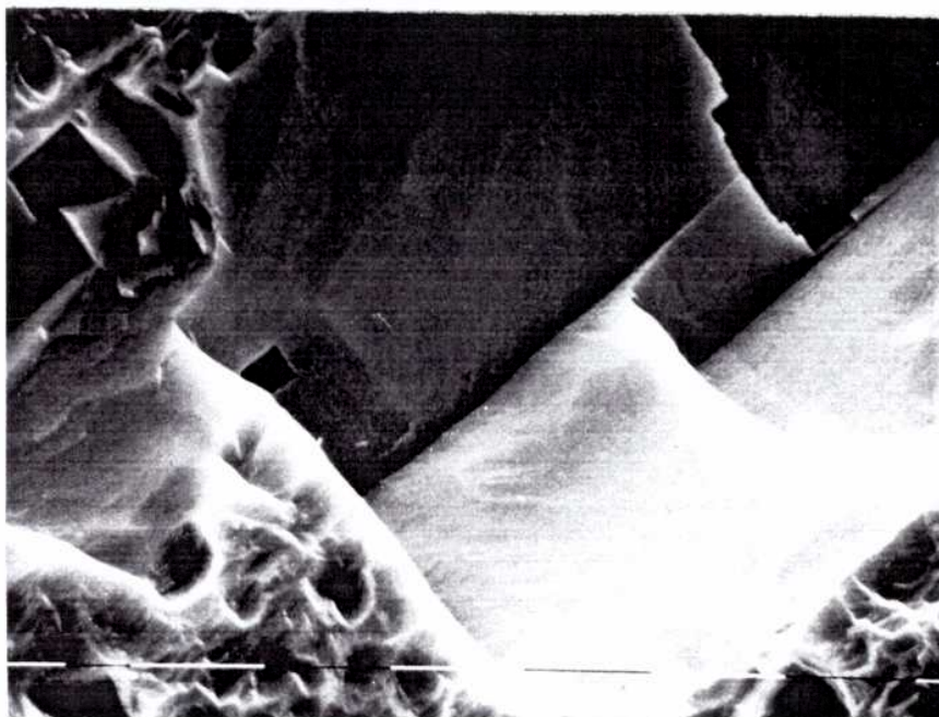
Figura 80. Aluminio. Plano (011). Figura de corrosión. Reactivo Tucker. SEM.
