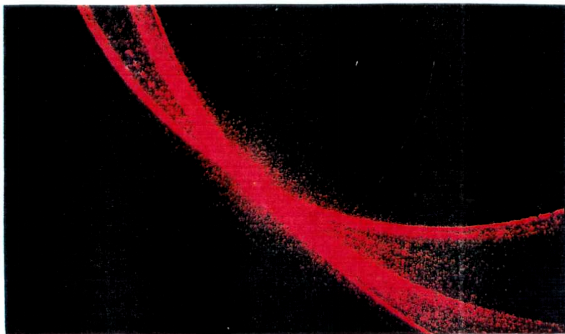
Figura 48. Figuras de difracción vistas en una pantalla ubicada a 80 cm. del microscopio. Las líneas producidas por el desbaste mecánico en una probeta de Cinc se encuentran ubicadas a 45^\circ de la proyección del haz laser sobre la muestra.
