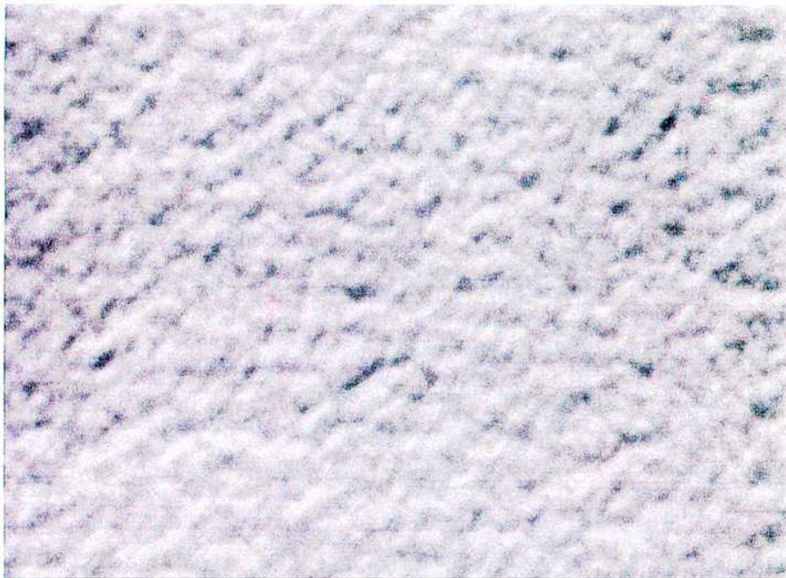
Figura 31. Policristal de Cinc. Grano A. SEM. Aumento: 7500x.
