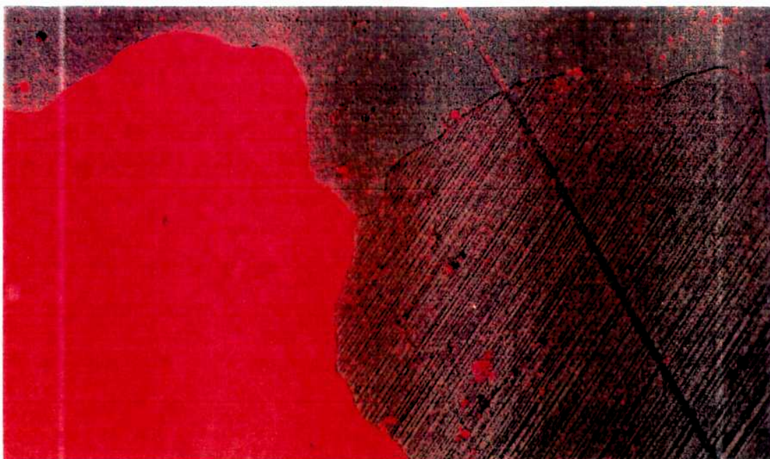
Figura 38. Policristal de Hierro, tras un ataque químico con el reactivo E (Klemm). Se notan las líneas en el grano de la derecha. El grano de la izquierda también posee líneas, las cuales se encuentran perpendiculares al haz laser (de allí su intenso color rojo). BFI + ULOI. Aumento: 200x.
